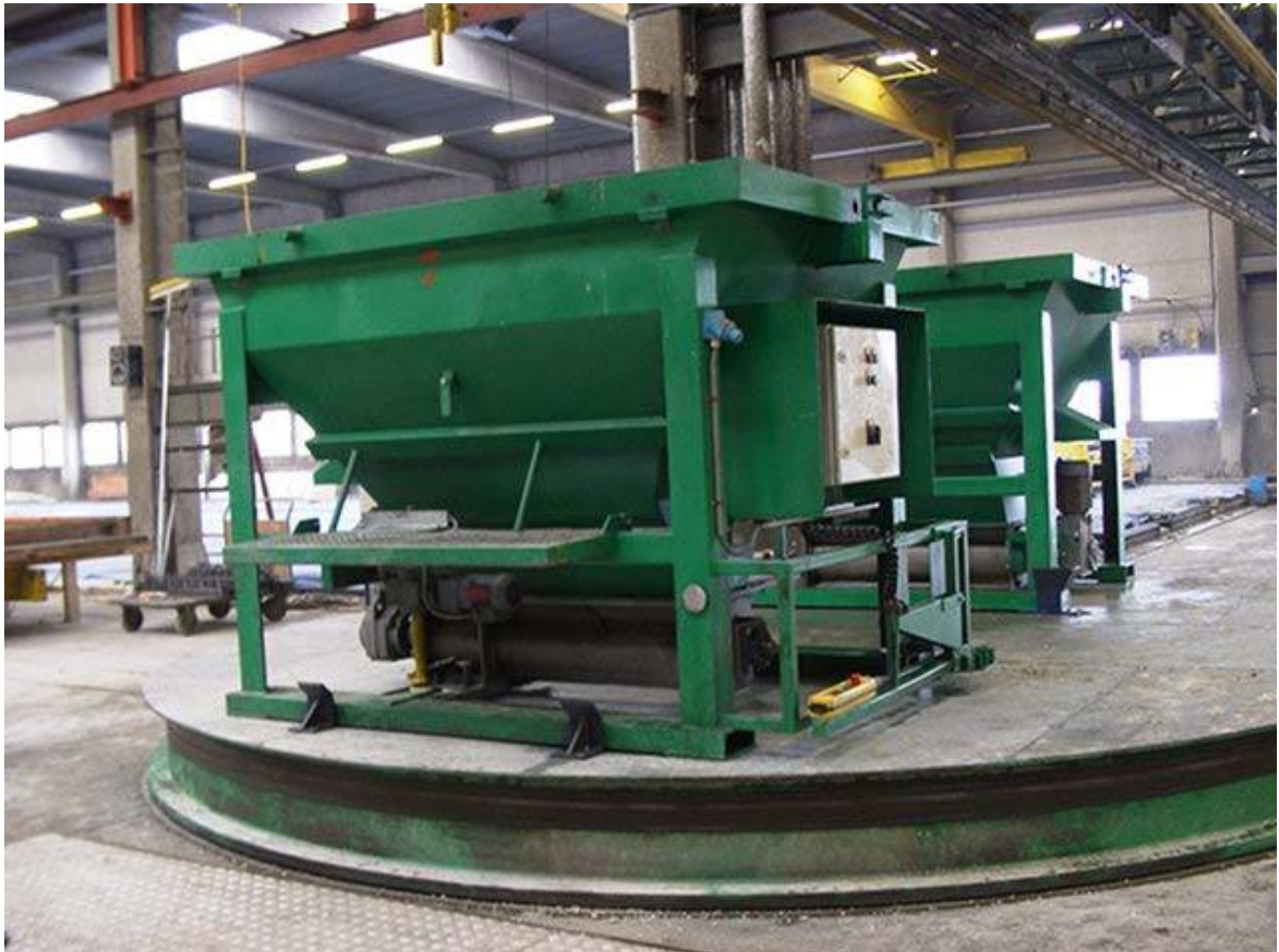
Obrázek 8: Užití šnekové jímky pro aktivaci samozhutnitelného betonu těsně před ukládáním.
