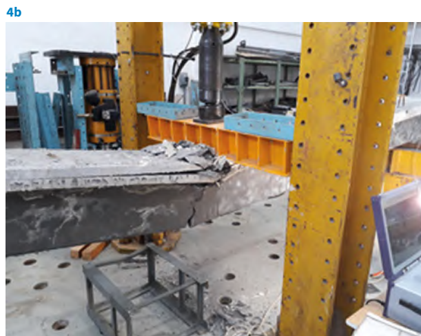
4 Způsob zatěžování a charakter porušení nosníku 4 Method of loading and nature of failure of the beam
