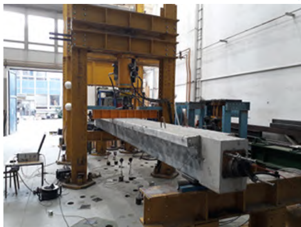
4 Způsob zatěžování a charakter porušení nosníku 4 Method of loading and nature of failure of the beam
