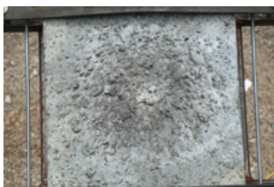
Materiál RC – běžný beton C30/37
