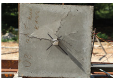
Materiál U – vysokopevnostní beton s ocelovými vlákny – UHPFRC
