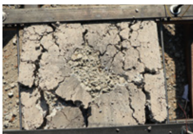
Materiál U – vysokopevnostní beton s ocelovými vlákny – UHPFRC
