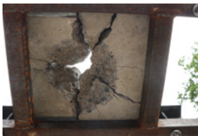
Materiál RC – běžný beton C30/37
