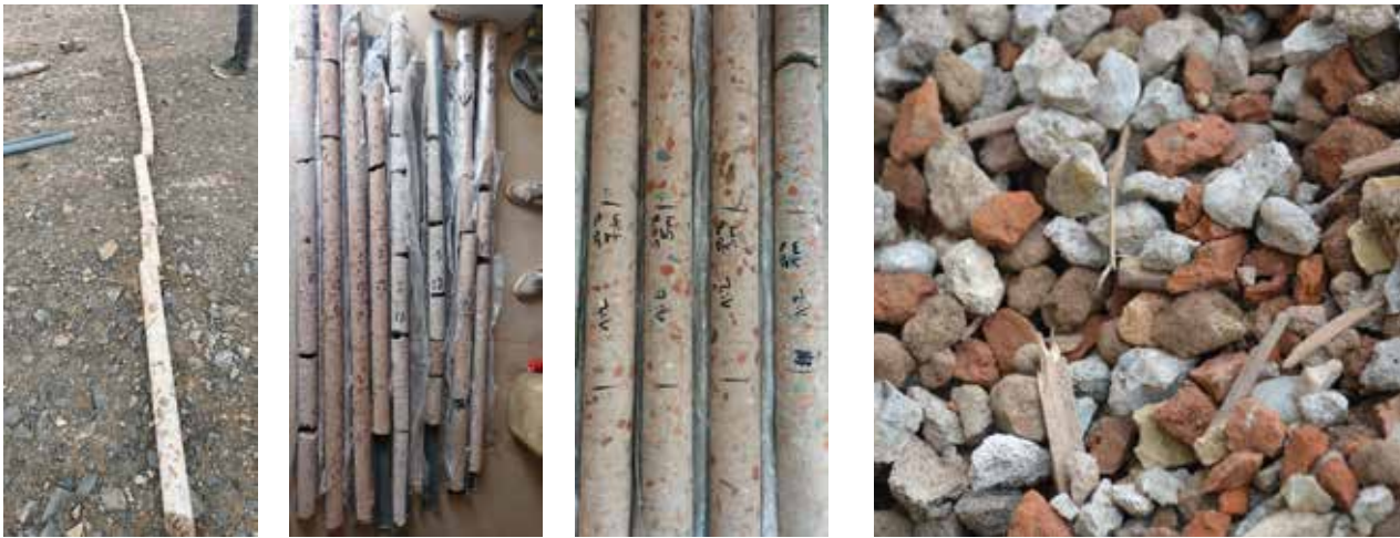
3 a) Vývrt z piloty z betonu s 15% náhradou recyklovaného kameniva po odebrání na stavbě, b) vývrty z obou pilot (s 15% i 50% náhradou kameniva RCA) převezené do laboratoře SQZ na Rohanském ostrově, c) vyznačení míst pro zkoušku pevnosti betonu v tlaku 4 Hrubé recyklované směsné kamenivo 5 Betonáž zkušebních pilot na staveništi dálnice D6 u obce Krupá
