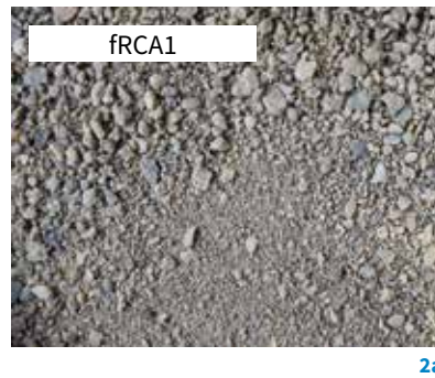
1 Přírodní kamenivo (NA): a) frakce 0–4 mm, b) frakce 4–8 mm, c) frakce 8–16 mm 2 Recyklované kamenivo (RA): a) betonový recyklát, b) cihelný recyklát
