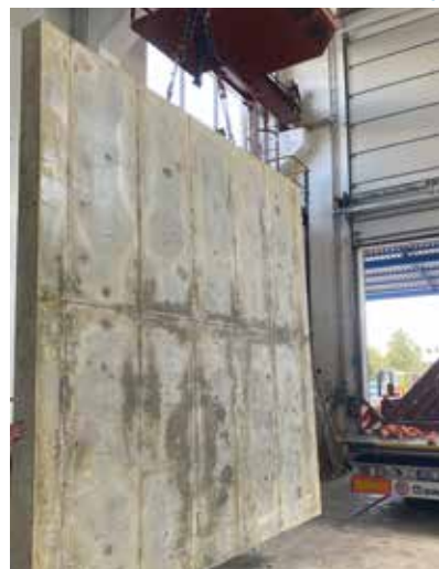
5 Betonáž železobetonových testovacích stěn 6 Ošetřování vybetonovaných stěn 7 Nakládání stěn k transportu do laboratoře 8 Manipulace s betonovými stěnami v laboratoři TZÚS Teplice
