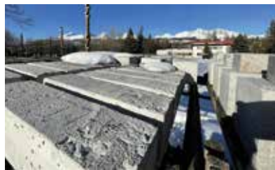
2 Skúšky z 2. etapy: a) obrusnosť, b) vznik trhlín, c), d) dlhodobá expozícia betónov 2 Tests from the 2nd stage: a) abrasion, b) crack propagation, c), d) long-term exposure tests of the concrete
