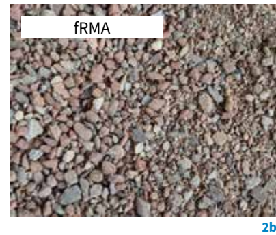
1 Přírodní kamenivo (NA): a) frakce 0–4 mm, b) frakce 4–8 mm, c) frakce 8–16 mm 2 Recyklované kamenivo (RA): a) betonový recyklát, b) cihelný recyklát
