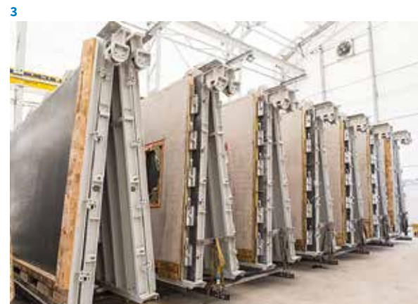
1 Schéma mobilní betonárny N3P (příprava armatury – příprava forem – realizace prefabrikovaných dílů v horizontální poloze – prvotní vyzrání a odbednění) 2 Díky postupnému procesu výroby na různých místech je možné vyrábět více prefabrikátů najednou 3 Vyzrávání prefabrikátů 4 Vzorový domek
