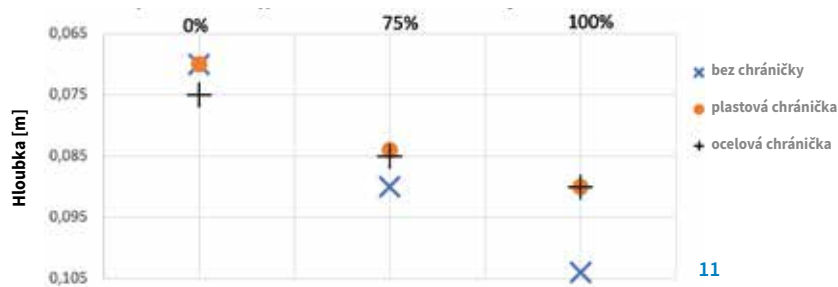
11 Hloubka ech v závislosti na typu chráničky a míře vyplnění 11 Depth of echoes in relation to the type of protector and the degree of filling
