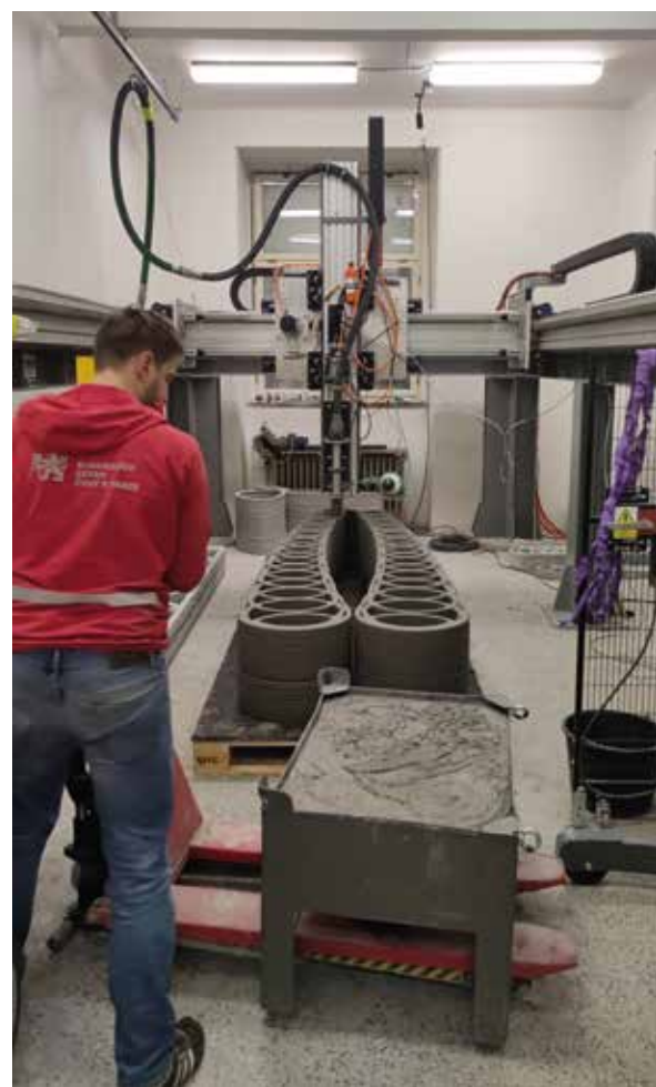
1 Robotická pohybová soustava TestBed – masivní portálový pohybový systém s tiskovou hlavou (extrudérem)
