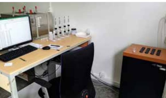
1 Kalorimetr TAM Air (vpravo) připojený k počítači 2 Schéma kalorimetrické zkoušky 3 Dávkočavec vody s nasazenou ampulí cementu při vkládání do přístroje 4 Připravené vzorky cementu a dávky vody společně s referenčními vzorky
