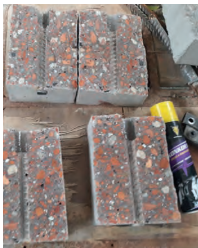
3 a), b) Zkouška soudržnosti s betonářskou výztuží
