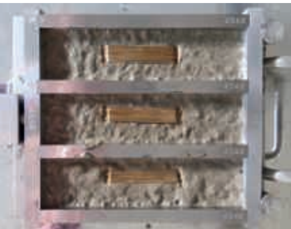
1 Výroba vzorků pro tvorbu řízených trhlin
