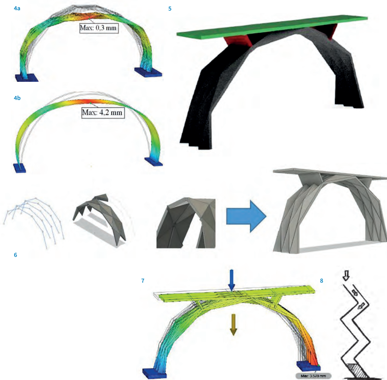
4 Zkoumání nárůstu tuhosti oblouku při užití prolamování pomocí softwaru 5 Model vláknobetonového origami mostu 6 Proces modelování origami konstrukce 7 Deformace modelu v softwaru 8 Způsob betonáže oblouku 9 Testování bednění i betonové směsi 4 Investigation of the rise in toughness of the arch using software for analysis of fracture 5 Model of a FRC origami bridge 6 Design process of the origami structure 7 Deformation of the model produced by the software 8 Method used for placing of concrete in the arch 9 Testing of the concrete mix and of the formwork
