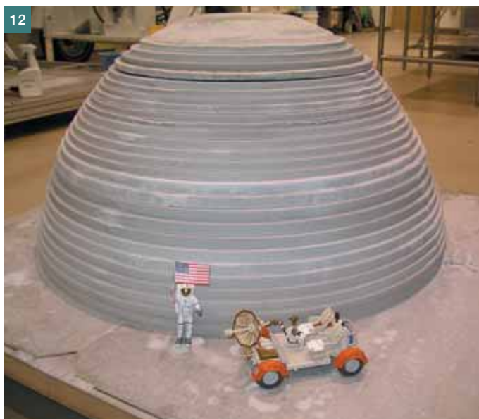
Obr. 10 Ukázka vzorové stěny realizované technologií 3D tisku vytlačováním cementové malty systémem Contour Crafting, USA
