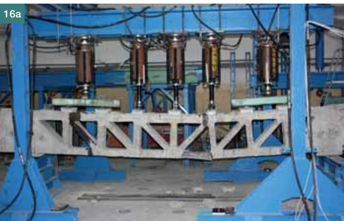
Obr. 14 Miesta merania pomerných pretvorení (1, 2, 3, 4) počas zaťažovacej skúšky ■ Fig. 14 Arrangement of relative strain measurements (1, 2, 3, 4) during the load bearing test
