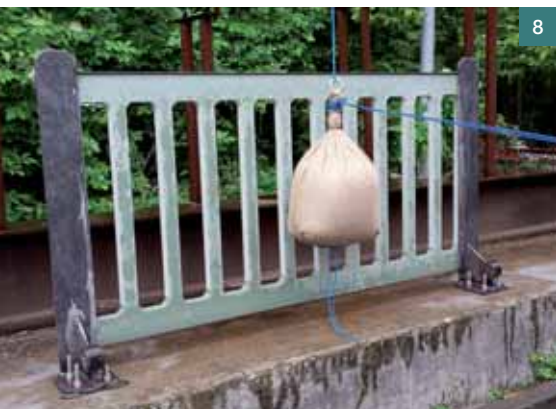
Obr. 8 Příprava dynamické zkoušky – náraz měkkého tělesa ■ Fig. 8 Preparation of a dynamic test – impact of a soft object
