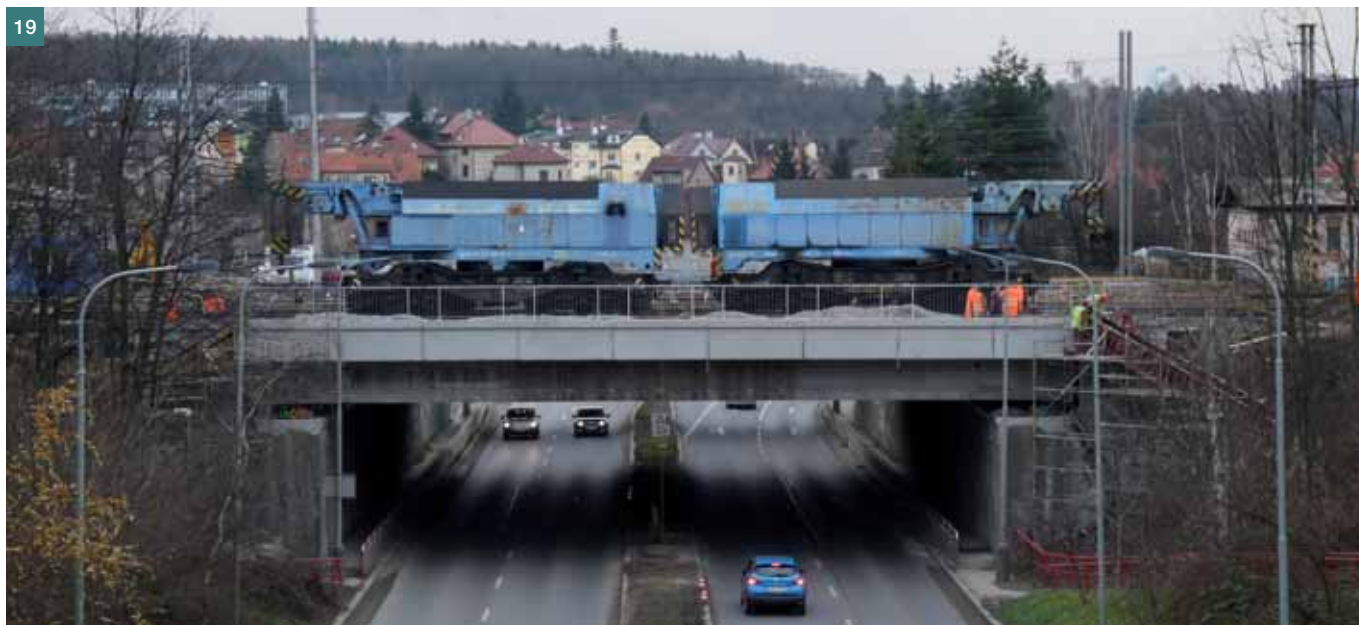
Obr. 19 Zatěžovací zkouška kolejovými jeřáby – I. etapa ■ Fig. 19 Loading test by track construction cranes – phase I
