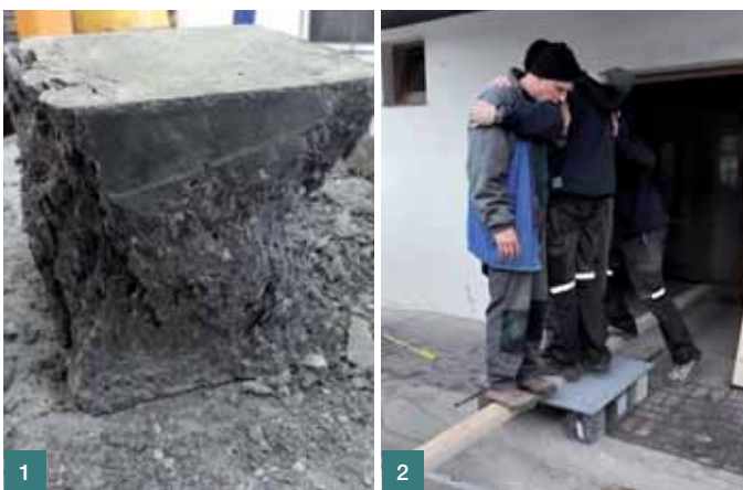
Obr. 2 Improvizovaná zatěžovací zkouška desky z UHPC 152 MPa, tloušťka desky 15 mm, vzdálenost podpěr 600 mm, únosnost čtyři muži uprostřed rozpětí
