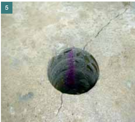
Obr. 5 Overenie skarbonatovanej vrstvy betónu na nosnej konštrukcii mosta
