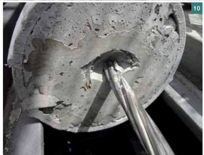
Obr. 8 Typický spôsob porušenia vzoriek typu „M“ | Fig. 8 Typical failure mode of the “M” type specimen
