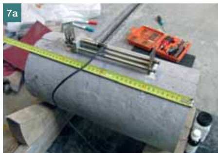
Obr. 7 Provedení zatěžovací zkoušky referenčního vzorku, a) příprava zkušební vzorku, b) reálné provedení, c) porušení vzorku ■ Fig. 7 Loading test of reference specimen, a) preparing a test specimen, b) realization, c) failure of specimen
