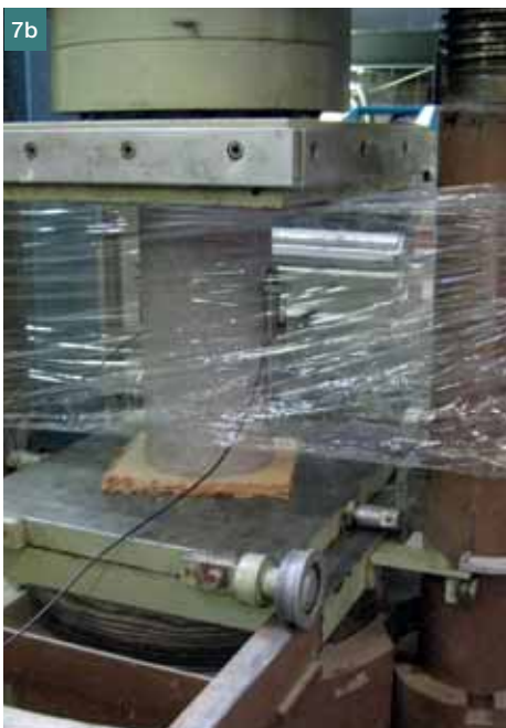
Obr. 8 Zatěžovací zkouška ovinutého vzorku: a) reálné provedení, b) porušení vzorku ■ Fig. 8 Loading test of confined specimen, a) realization, b) failure of specimen
