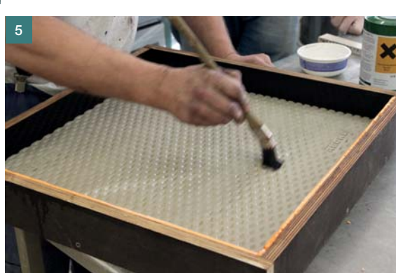
Obr. 5 Pozorné nanášení odbědňovacího prostředku ■ Fig. 5 Careful application of the demoulding agent
