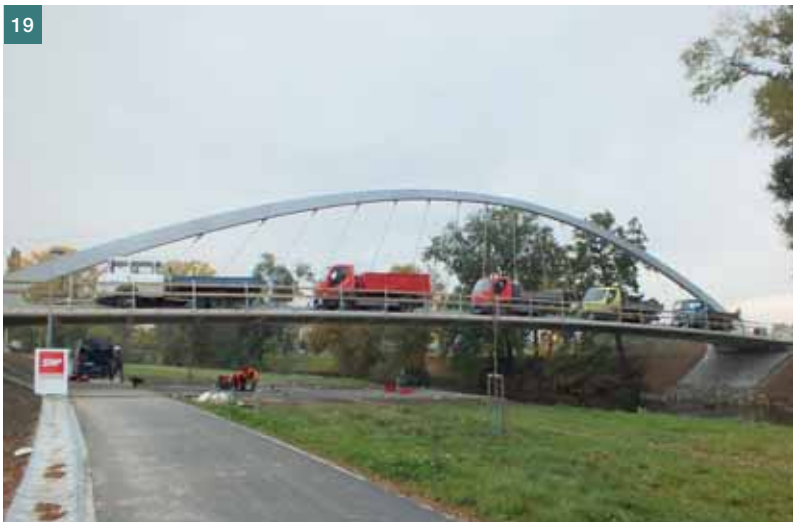
Obr. 18 Zatěžovací zkouška ■ Fig. 18 Loading test
