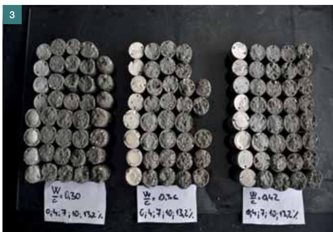
Obr. 3 Sada skúšobných telies ■ Fig. 3 Set of testing specimens
