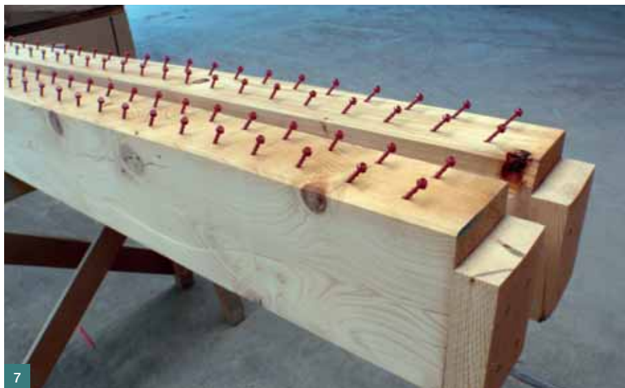
Obr. 7 Detail dřevěných nosníků se spřahovacími trny ■ Fig. 7 Detail of timber beams with the connectors
