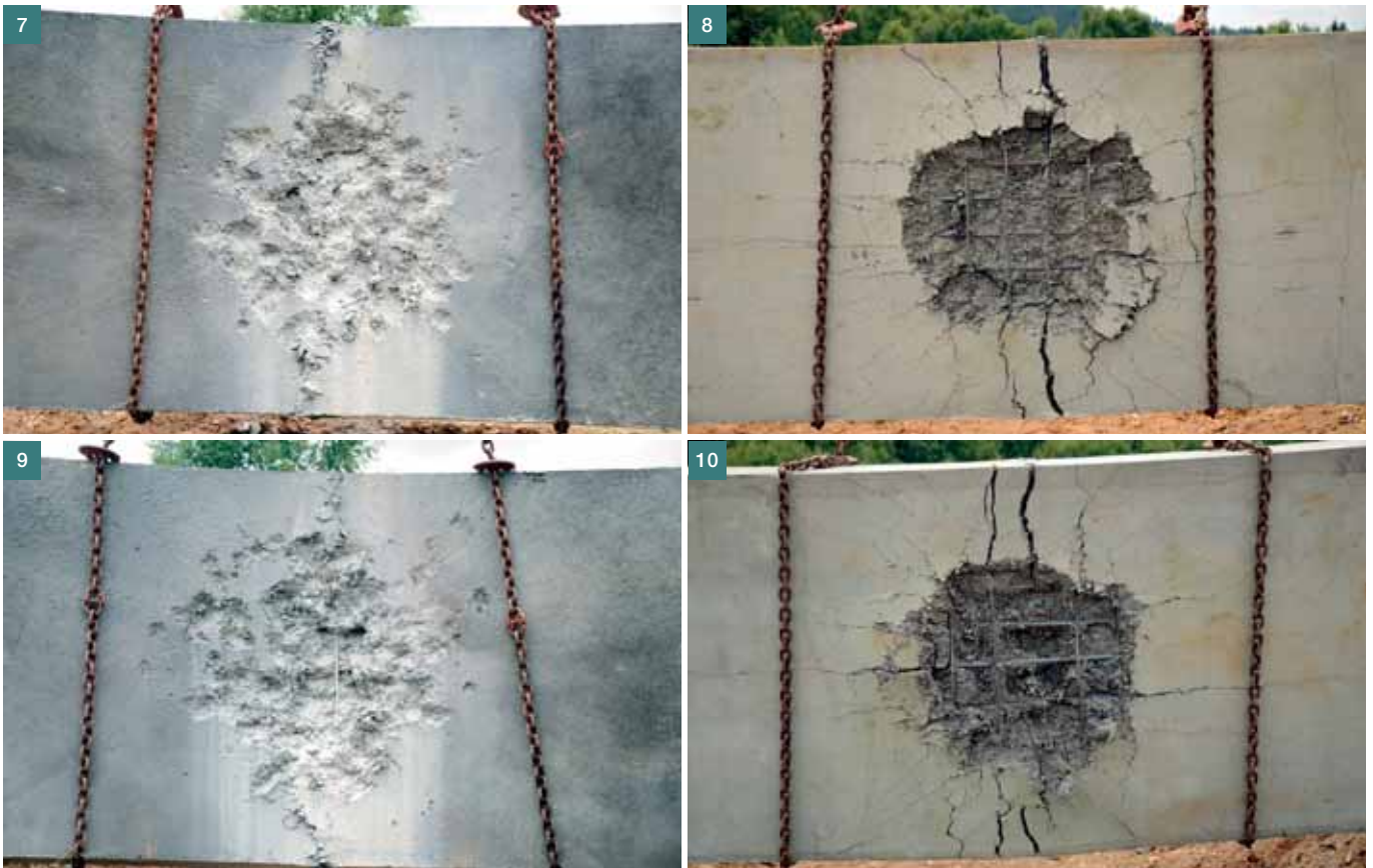
Obr. 1 Vzorek č. 1 poškozený výbuchem – horní povrch ■ Fig. 1 Damaged specimen No. 1 after blast – top view
