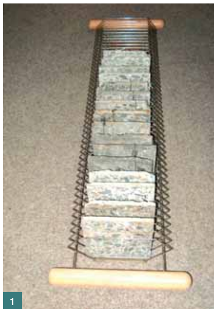
Obr. 1 Způsob uložení vzorků ve stojanech, použito stejné uspořádání pro všechna prostředí ■ Fig. 1 Method for the placement of samples in racks; the same arrangement is used for all environments
