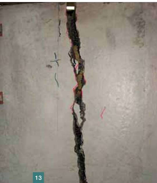
Obr. 11 Porušení drátkobetonového segmentu tlakem ■ Fig. 11 Damage in fibre reinforced concrete segment loaded in compression
