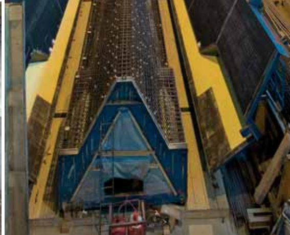
Obr. 9 Výrobní hala s ocelovým bedněním pro střešní nosníky ■ Fig. 9 Factory hall with steel formworks for the roof beams
