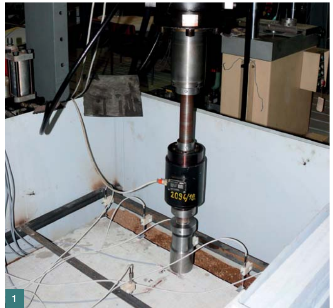
Obr. 1 CB deska v testovacím boxu, zatěžovací systém ■ Fig. 1 Concrete slab in testing box, loading system
