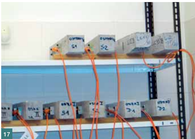
Obr. 18 Sledování dotvarování zkušebních vzorků v laboratoři ■ Fig. 18 Monitoring of creep in laboratory conditions
