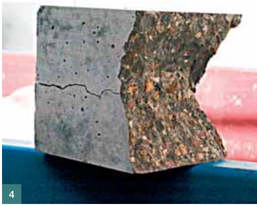
Obr. 4 Vzorek ve tvaru krychle nepravidelně porušený v důsledku tvarové nedokonalosti ■ Fig. 4 Irregularly destroyed cubic specimen due to imperfection in its shape
