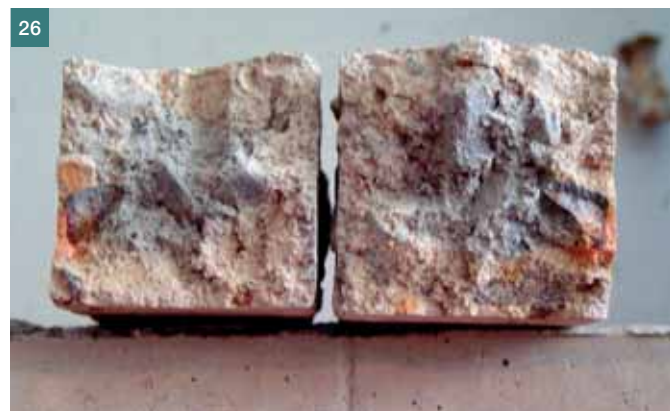
Obr. 26 Charakter POP betonu po výpalu na 650 °C ■ Fig. 26 POP concrete after firing (600 °C)
