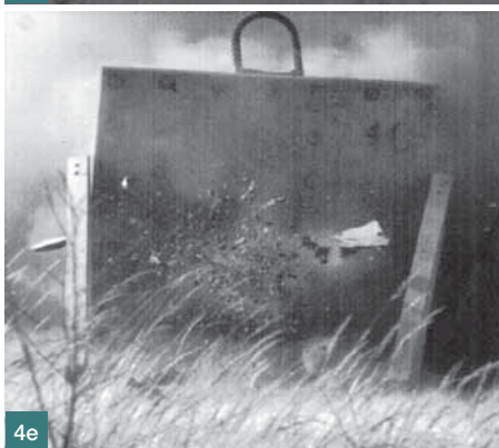
Obr. 3 Zkušební deska z drátkobetonu, a) pohled na nálevku vzniklou výbušninou PIHx30, b) pohled z lícové strany – vznik odštěpků ■ Fig. 3 The test plate of steel fibers reinforced concrete, a) view of the funnel created by explosive PIHx30, b) view from the front side – the emergence of spall
