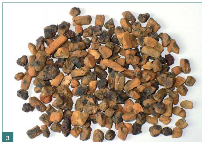
Obr. 3 Použité pórovité kamenivo – agloporit frakce 8–16 mm Fig 3 Used porous aggregate – agglomerite of 8 – 16 mm fraction
