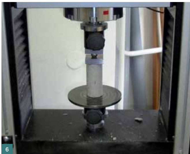
Obr. 5 Zkušební těleso z malty Sakret BE 04/15 s krystalizační příměsí Penetron Admix ■ Fig. 5 Test specimen – Sakret BE 04/15 mortar with crystalline admixture Penetron Admix
