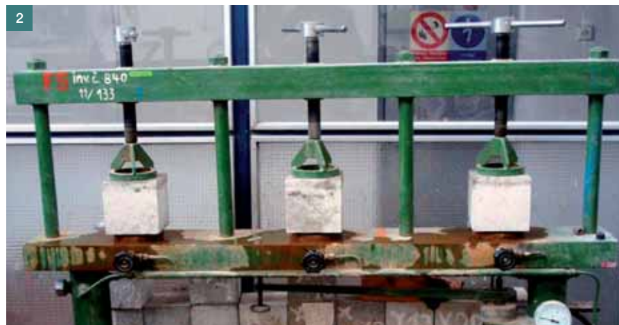
Obr. 3 Průsak tlakové vody v betonu C16/20 s krystalizační příměsí Penetron Admix v porovnání se stejným betonem bez příměsí ■ Fig. 3 The seepage shape in C16/20 concrete with crystalline admixture Penetron Admix compared with the same concrete without admixture
