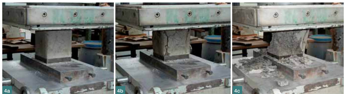
Obr. 4a, b, c Postupné zatěžování zkušebního tělesa z betonu C16/20 s krystalizační příměsí Penetron Admix v hydraulickém lisu ■ Fig. 4a, b, c Consecutive loading of test specimen (C16/20 concrete with crystalline admixture Penetron Admix) in hydraulic press
