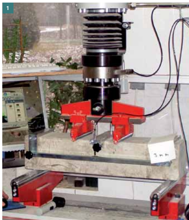
Obr. 1 Test trámku čtyřbodovým ohybem ■ Fig. 1 Four point bending test of the beam
