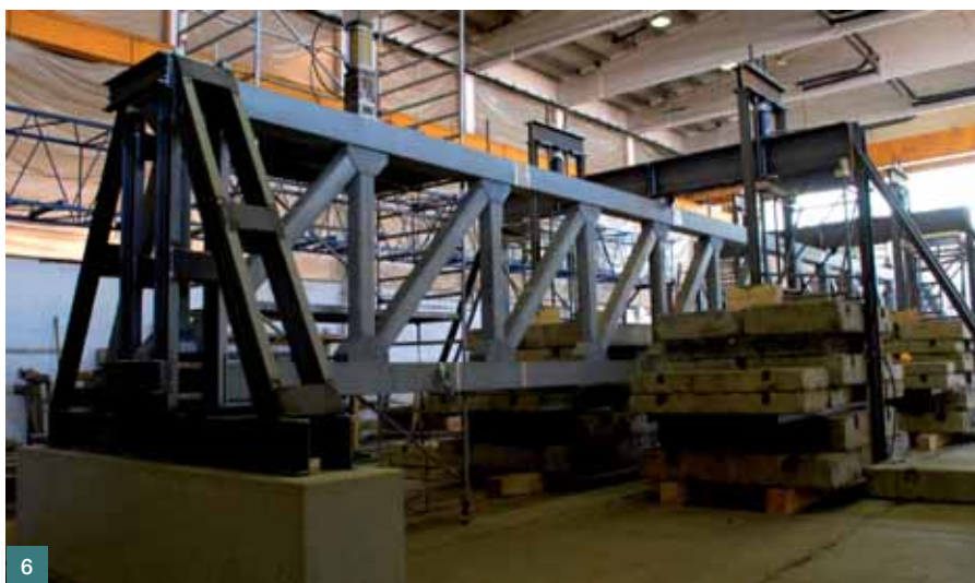
Obr. 6 Příhradových vazníků ve zkušební
