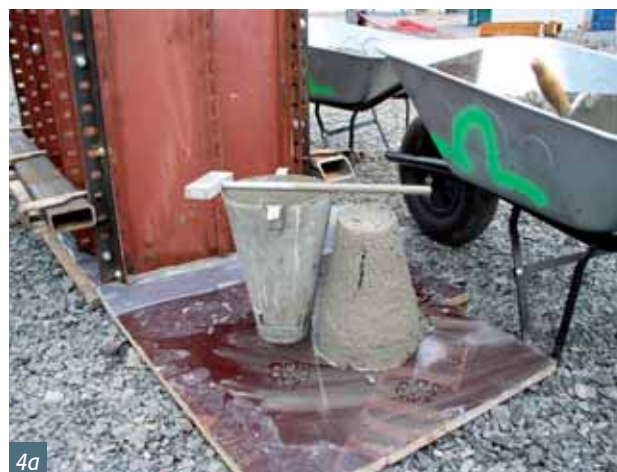
Obr. 4 Sledování vývoje zpracovatelnosti betonu v čase, sednutí Abramsova kužele po 1 h od uložení směsi do formy, a), b) Fig. 4 Test of fresh concrete consistency
