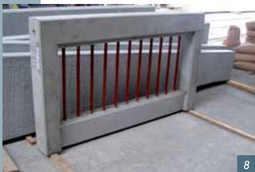
Obr. 7 Forma na panel zábradlí připravená k betonáži
