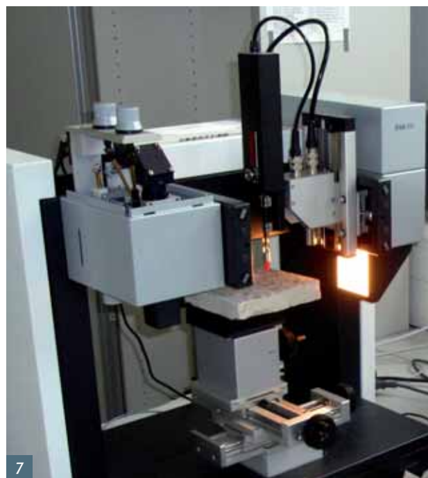
Obr. 6 Základ zkušebních těles – betonová krychle s aplikovaným krystalizačním nátěrem
