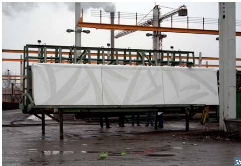
Obr. 3 Projekt kancelářské budovy v Kumotie, a) fasáda ve výstavbě, b) hotové fasádní panely připravené k převozu na stavbu, c) detail povrchu panelu
