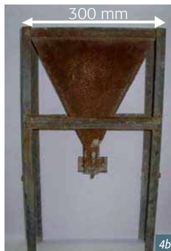
Obr. 4 Zařízení na zkoušky malty mini-slump flow a V-funnel Fig. 4 Mini-slump flow and V-funnel apparatus for mortars
