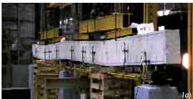
Obr. 1 Zkoušené prefabrikované prvky: a) deformace nosníku s výztuží z oceli vysoké tažnosti po dosažení únosnosti, b) deformace desky s výztuží z oceli vysoké tažnosti po dosažení únosnosti
