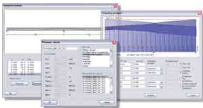
Obr. 5 Panely definice předpětí v RTbalken EXPERT Fig. 5 The input dialogs of prestressing
