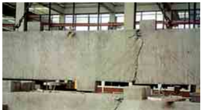
Obr. 3 Stěnový nosník po zkoušce v laboratoři Fig. 3 Deep beam after testing in laboratory
