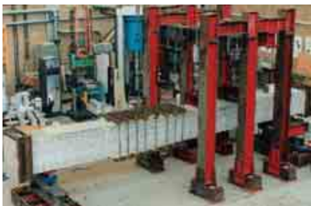
Obr. 8 Test části mostu poškozené alkalicko-křemičitou reakcí Fig. 8 Test of a part of a bridge, attacked by the alkali silica reaction
