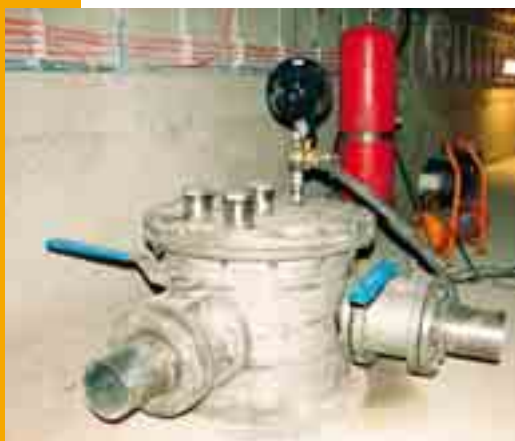
Obr. 10 Tlaková zkouška zhlaví odlehčovacího prvku před dokončením průvrtu základovou deskou
