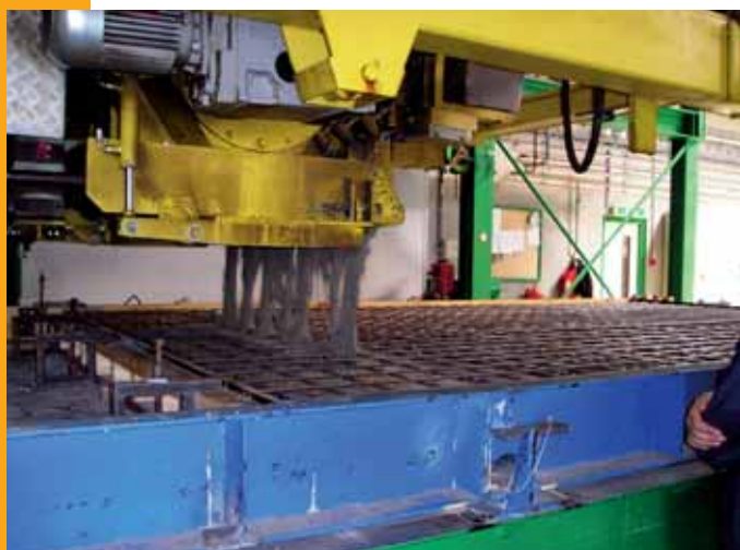
Obr. 15 Ukládání samozhutitelné betonové směsi Fig. 15 Placement of self-compacting concrete mix
