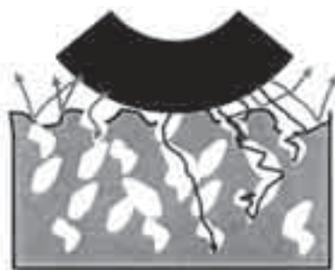
Obr. 1 Schéma absorpce hluku způsobeného kontaktem pneumatiky s vozovkou pomocí EPC, část hluku se odráží zpět, část hluku je absorbována sítí propojených pórů ve vozovce; běžná vozovka odráží téměř všechnu zvuk
