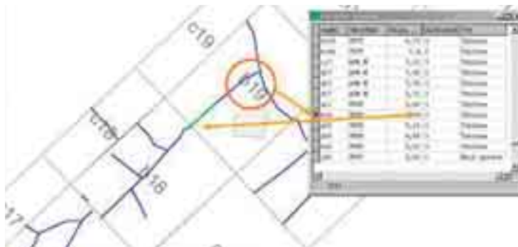
Obr. 9 Grafický záznam trhliny na desce b19 TAXIWAY Delta a její záznam v databázi poruch
